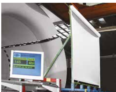
Test odporności na napór wiatru - 145 km/h.
